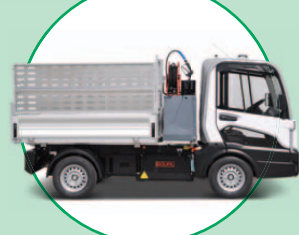
Kombince sklopka / vysokotlaké čištění
