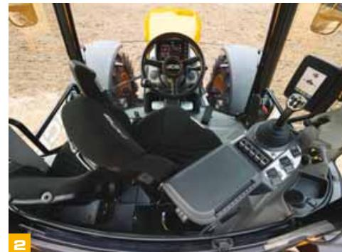
**3** Plně nastavitelné sedadlo a sloupek řízení zajistují ideální pozici řidiče.
