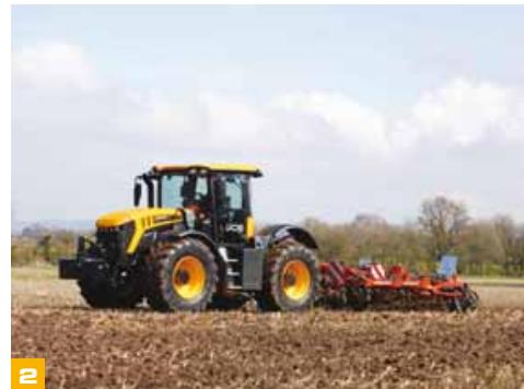
**2** Aktivní odpružení rychle reaguje na připojení nářadí k závěsu nebo zapřažení samostatného postřikovače či rozmetadla umělých hnojiv a nastaví vyšší tuhost pružin, aby byla i při zvýšené váze zachována světlá výška, zdvih při pružení a stabilita kol.
