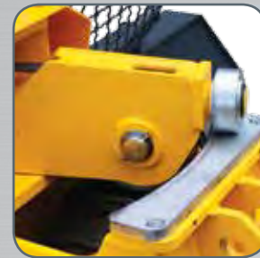
Vedení pro přesnější navíjení ocelového lana na bubnu (sériově).
