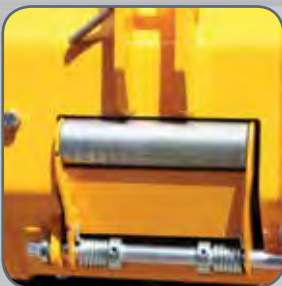
Přítlačný válec na lano pro přesnější navíjení ocelového lana.
