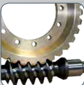
85G 2x85G 1. Pohon šňečkovým převodem a převodem s čelními ozubenými koly. 2. Šnek je vyroben z vysoce legované oceli, cementovaný a broušený. Šnekové kolo vyrobeno ze speciálního bronzu.
