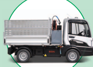
Kombince sklopka / vysokotlaké čištění
