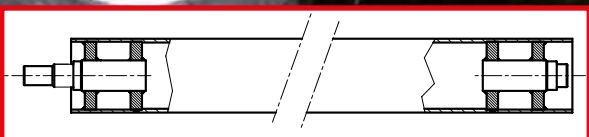
COMFORT H 2250-2500 ■ ROTORE CON DOPPIA FLANGIA ■ ROTOR WITH DOUBLE FLANGE ■ ROTOR AVEC DOUBLE FLASCHE ■ ROTOR MIT DOPPEL-FLANSCH ■ ROTOR CON DOBLE REBORDE
