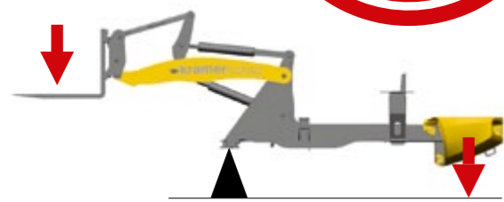
Konstantní pákový poměr pro zajištění konstantního užitečného zatížení
