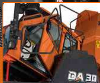
Bezpečnostní zábradlí kolem celé kabiny
