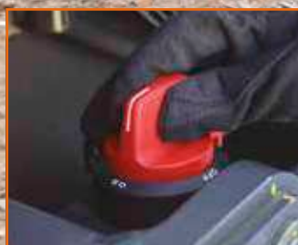
Přepínač odpojení baterie
