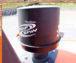
Odstředivý předřazený čistič Top Spin™ od společnosti Donaldson®
