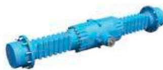
Náprava s diferenciálem s omezeným prokluzem
