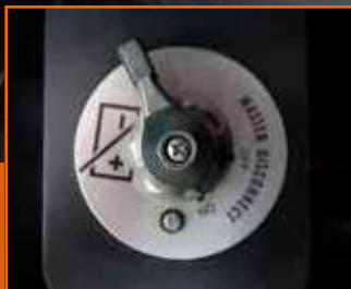
Přepínač odpojení baterie
