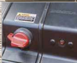
Přepínač odpojení baterie
