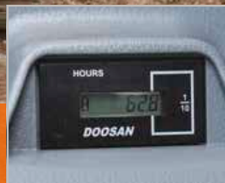
Počítadlo hodin (z úrovně terénu)
