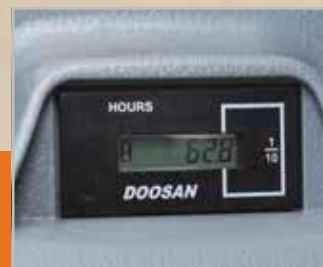
Počítadlo hodin (z úrovně terénu)
