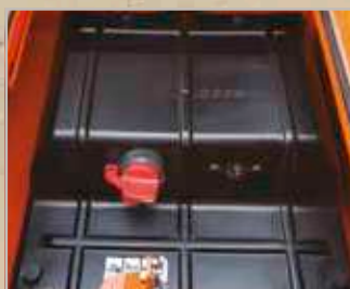
Přepínač odpojení baterie
