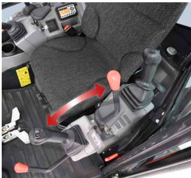
Funkce naklápění ovládacího stojanu
