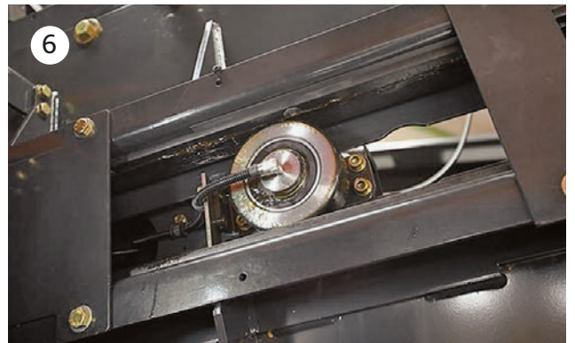
HOCHLEISTUNG-PRESSKOLBEN – 46 HÜBE PRO MINUTE, FÜHRUNGSROLLEN MIT 12,5 CM DURCHMESSER
