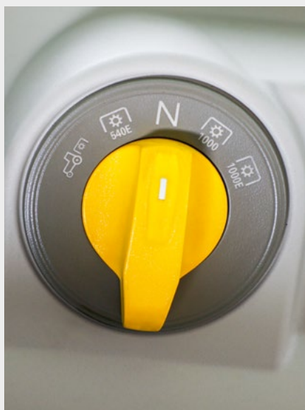
↑ Elektrohydraulická změna rychlosti PTO včetně pozice neutrálu N.
