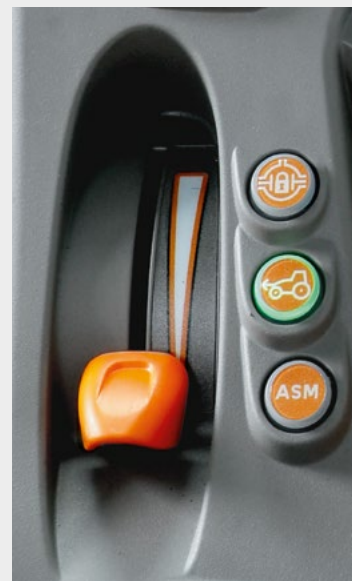
↑ Elektrohydraulicky ovládaný pohon všech kol a uzávěrky diferenciálů včetně ASM.
