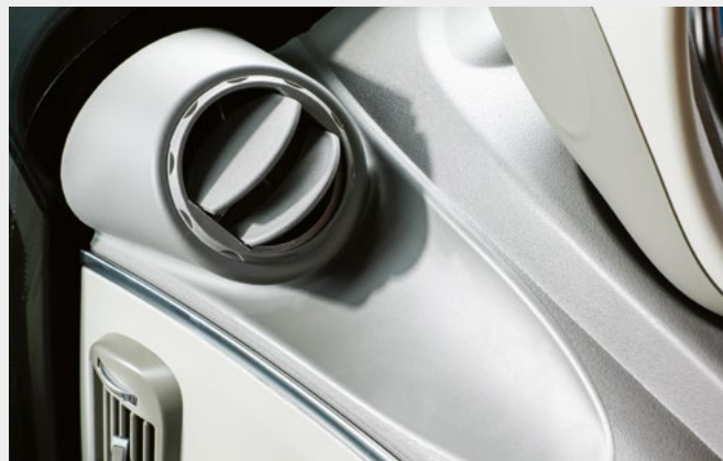
↑ Nové rozložení klimatizačního systému pro vyšší průtok vzduchu a méně hluku.
