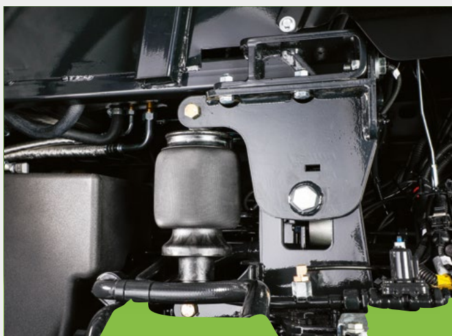
↑ Pneumatické odpružení kabiny pro hladkou jízdu.
