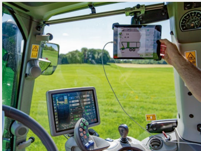
↑ Volitelně dostupná upevňovací lišta pro externí monitory.
