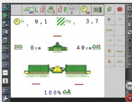
↑ ISOBUS aplikace v iMonitoru3 – flexibilní struktura ovládacího panelu zvyšuje pohodlí.
