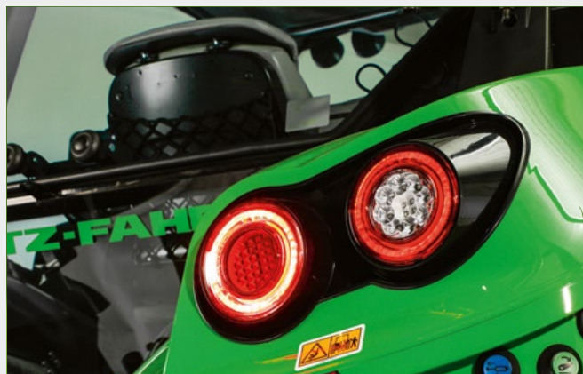
Pro vyšší bezpečí a modernější vzhled lze traktor vybavit LED směrovými světly.
