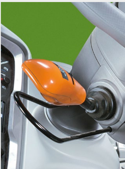
↑ Reverzace PowerShuttle s nastavitelnou agresivitou.
