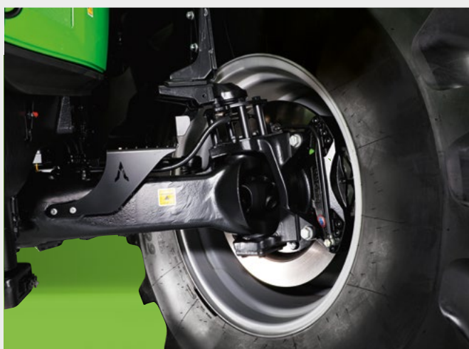
↑ Suché kotoučové brzdy pro maximální brzdný výkon.
