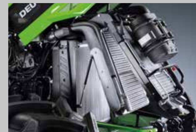
Snadná a rychlá údržba díky nově zkonstruovaným chladičům z hliníku, které se dají plně rozevřít, čímž tím přispívají i k vysoké životnosti.
