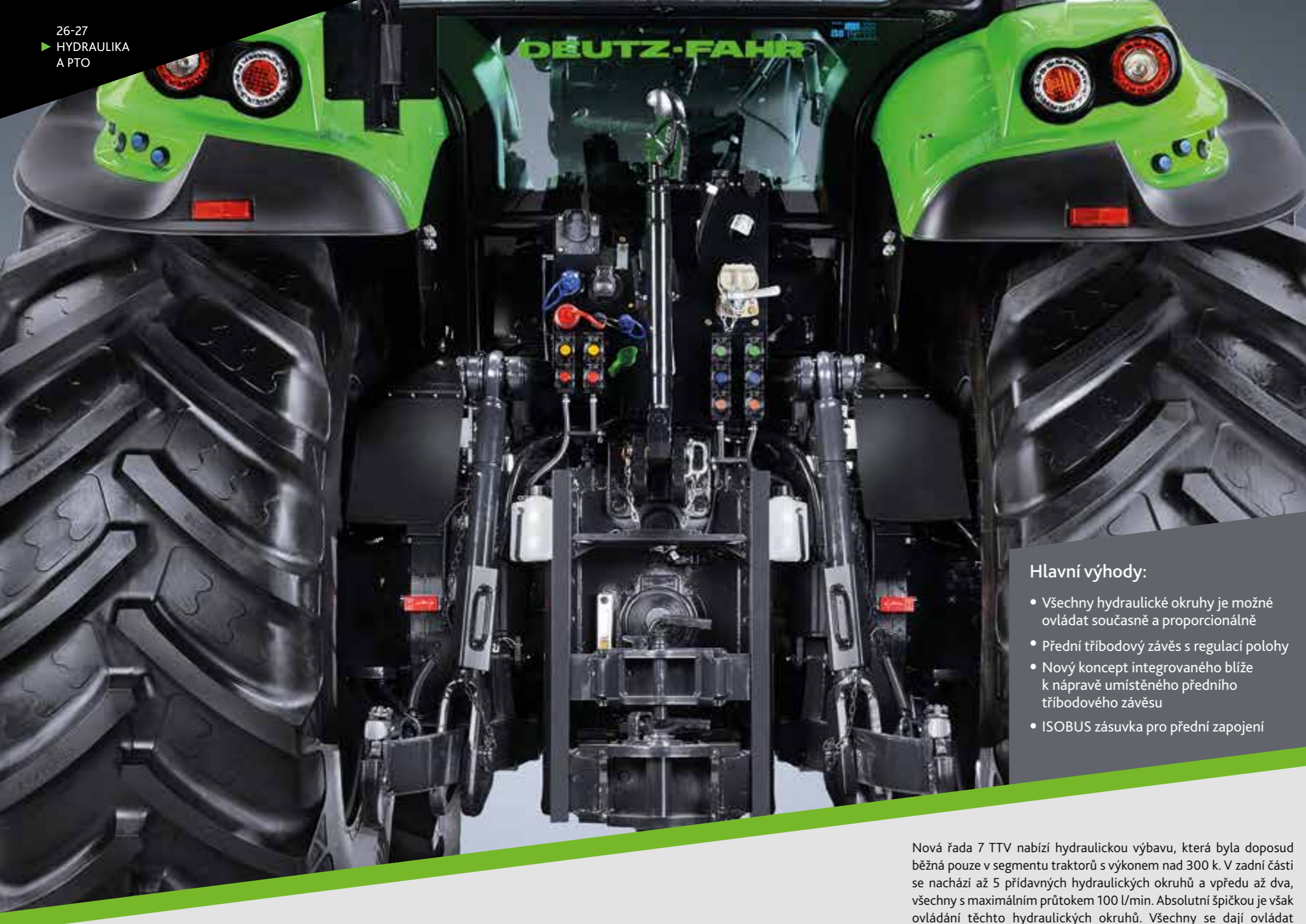
Až 5 hydraulických okruhů vzadu a 2 vpředu. Plně integrovaný přední tříbodový závěs je umístěn blíže k těžišti traktoru.
