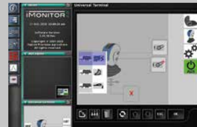
ISOBUS integrace - ovládání připojeného zařízení je možné provádět pomocí traktorových ovladačů.
