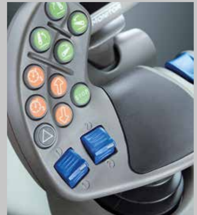
Pro optimalizaci pracovních procesů je možné uložit až 4 pojezdové rychlosti a opět je vyvolat.
