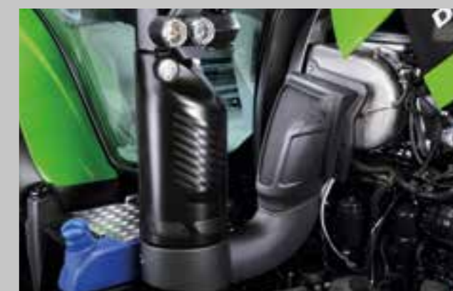
SCR systém a pasivní filtr pevných částic se starají o minimální emise, nízkou spotřebu paliva a celkově nízké provozní náklady.
