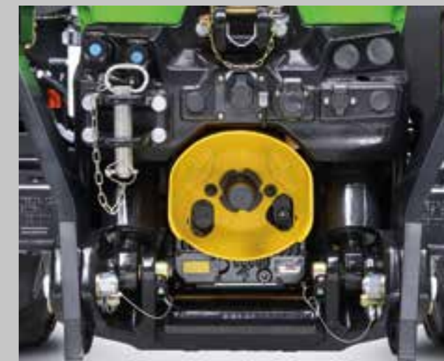
Až 5 hydraulických okruhů vzadu a 2 vpředu. Plně integrovaný přední tříbodový závěs je umístěn blíže k těžišti traktoru.
