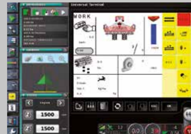
Příprava na systém TIM (Tractor Implement Management), díky kterému traktor automaticky vykonává pokyny připojeného zařízení.
