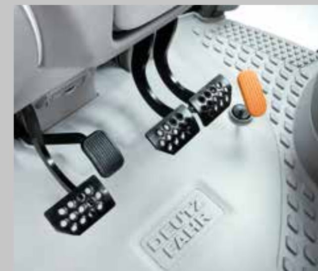
Posilovač brzd garantuje již při lehkém sešlápnutí pedálu dostatek brzdného výkonu.
