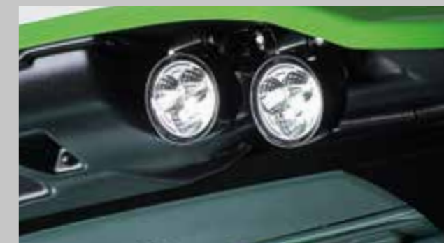
Zcela jedinečný na trhu traktorů je balíček LED pracovních světel, každé s výkonem 2 500 lumenů.
