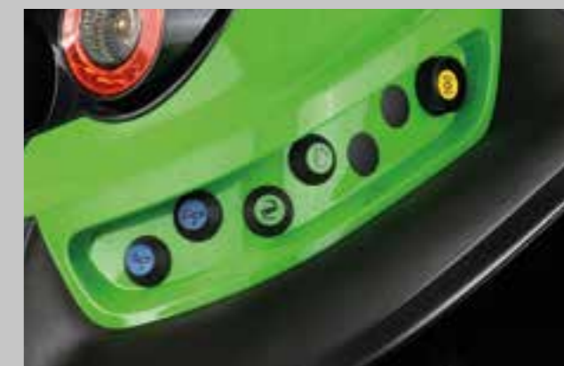
Externí ovládání hydraulických okruhů, zadního tříbodového závěsu a vývodové hřídele na obou stranách.
