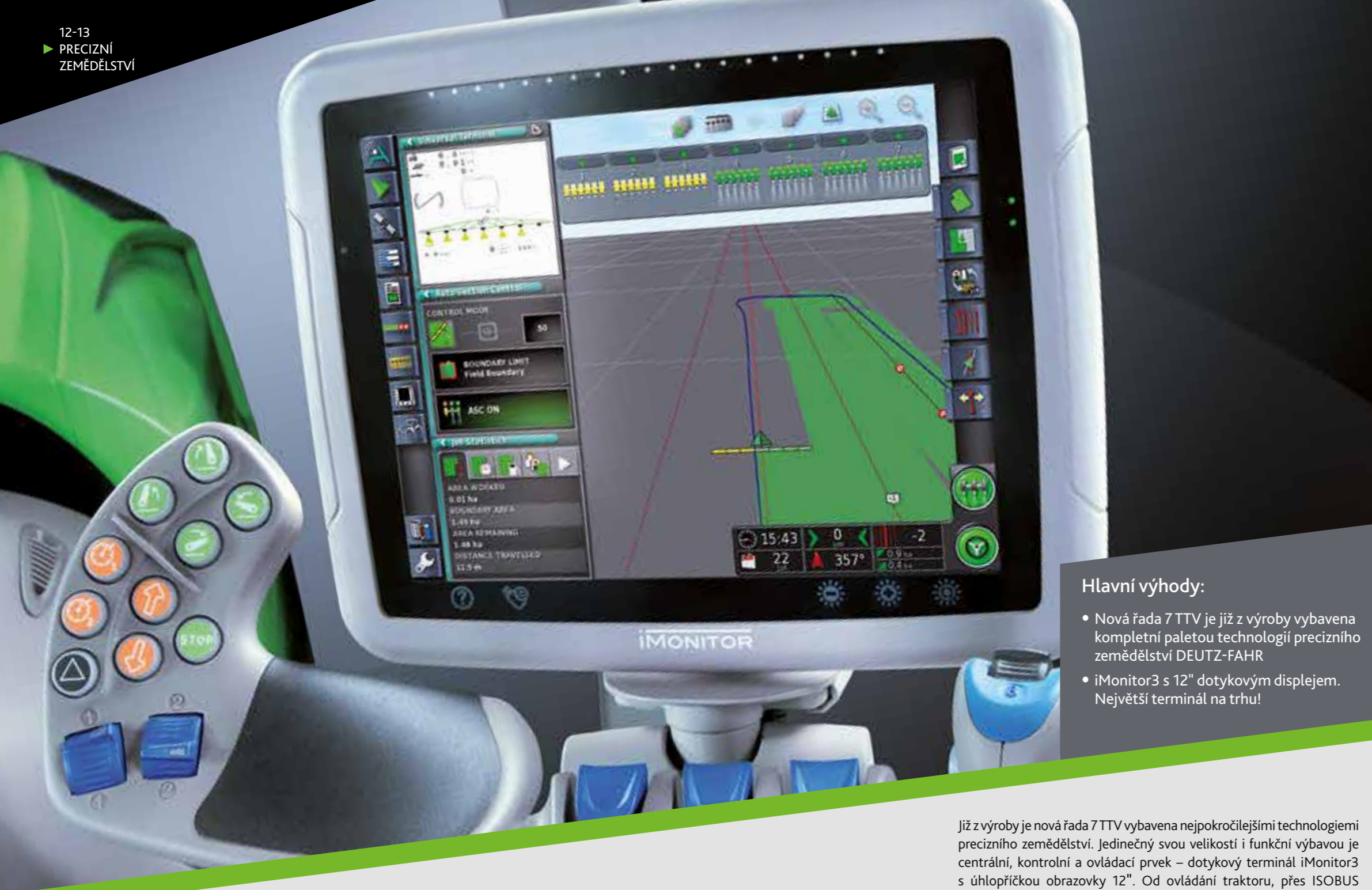
Příprava na systém TIM (Tractor Implement Management), díky kterému traktor automaticky vykonává pokyny připojeného zařízení.
