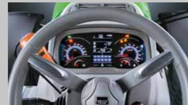
Nová analogově-digitální přístrojová deska InfoCenter PRO s barevným displejem pro optimální znázornění informací.
