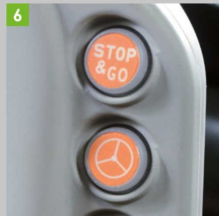
6 Systém rychlého natáčení předních kol SDD a funkce Stop&Go.
