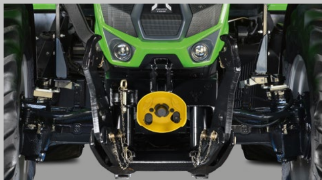
Robustní přední tříbodový závěs zdvihne až 2.880 kg. K dispozici je též Comfort-pack s dalším hydraulickým okruhem vpředu a externím ovládaním pro tříbodový závěs.
