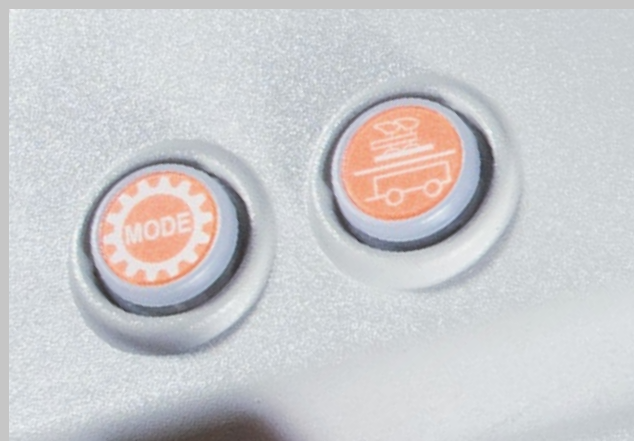
Rychlostní rozsah (pole/doprava) lze vybrat elektrohydraulicky: režim pole/doprava lze měnit v klidu nebo při řízení (max. 15 km/h).
