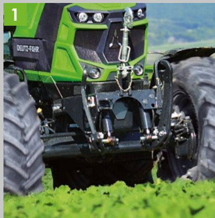
1 Až 22 různých konfigurací hydraulického systému. Například plně integrovaný přední tříbodový závěs.
