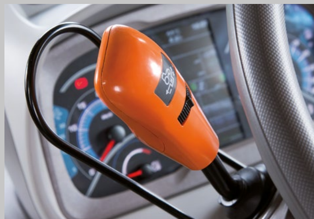
Elektrohydraulická reverzace Powershuttle SenseClutch pro precizní a bezpečnou změnu směru jízdy i s nákladem bez přerušení točivého momentu.
