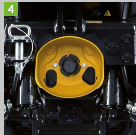
4 Pro ještě větší všestrannost volitelná přední vývodová hřídel.
